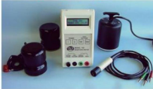
Trek Model 152 面电阻测试仪是用来精确测量各种传导、损耗、绝缘的面电阻，Model 152是采用了几种ESD标准的测量技术来进行面电阻和面电阻系数的测量，包括采用S2.1标准对静电衣的测量，S4.1标准对工作环境表面的测量，S7.1对地面电阻的测量，S11.11对平板材料的测量。它是通过各种不同电极结构的测量探头来进行面电阻和面电阻系数的测量。
