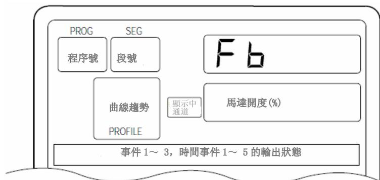
2G 輸出型(輸出型號為 2G 的儀錶)的顯示通道側是僅在位置比例輸出時的顯示。
