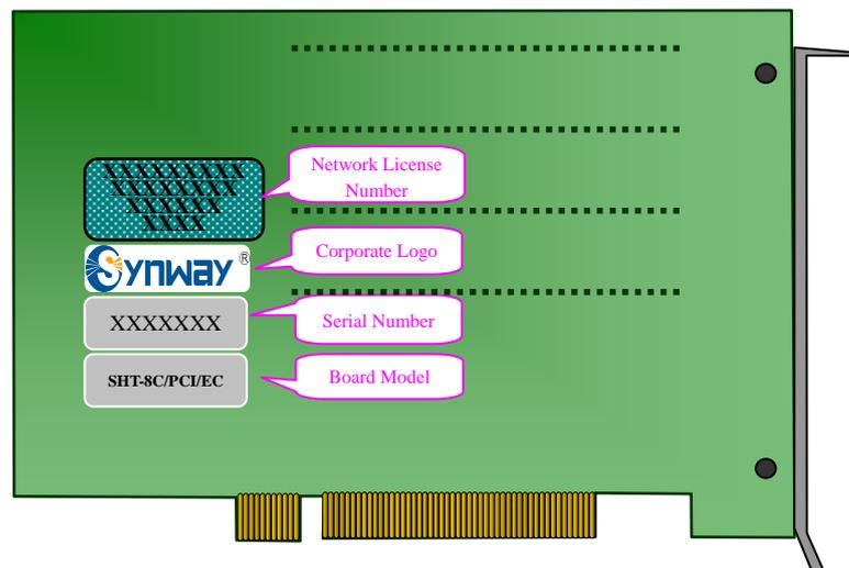
图 2-2 主板示意图(后视图)
