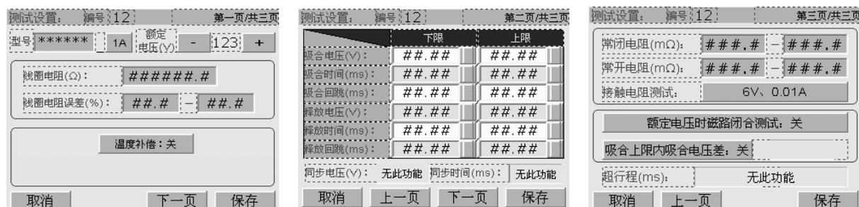
**6.1 第一页：**用来设置产品型号、触点类型、额定电压、线圈电阻、线圈电阻误差、温度补偿等相关
