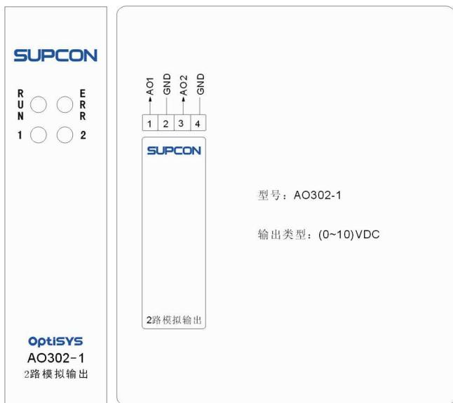
图 2-14 AO302-1 模块指示灯和接线
