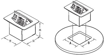
在加工表面切口时，请务必参考上述的表面切口尺寸，否则 Extron 对此引起的问题概不负责。
