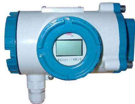
**HVP 智能阀门定位器**是气动执行器实现智能化的必备附件。HVP12 是隔爆型智能阀门定位器，它的工作原理与模拟定位器截然不同。它与气动执行器组成一个反馈控制回路，在这个回路中，显示的调节阀位置反馈信号作为被控制的变量，与给定信号值在微处理器中做比较，这两个信号的偏差通过主控板的输出口，发出不同步长的脉冲信号，控制 I/P 转换单元输出口的压力输出，从而驱动调节阀动作。
