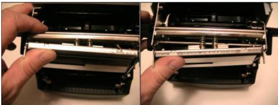
3) 卸下将绿色地线固定到支架上的螺丝。
