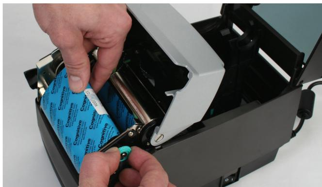
图 2-34. 将色带卷取核心送入卷轴槽口
