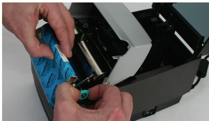
图 2-33. 将卷轴向外拉以插入卷取卷筒
