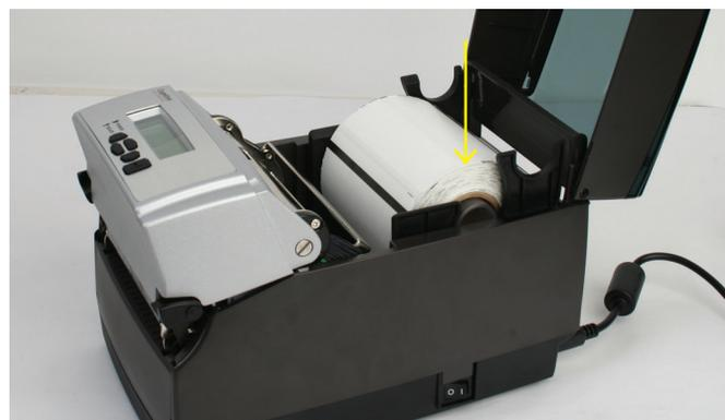
图 2-46. 下推卷筒右侧以锁定介质导向装置
