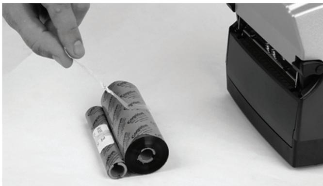
图 2-22. 取走色带上的胶带
