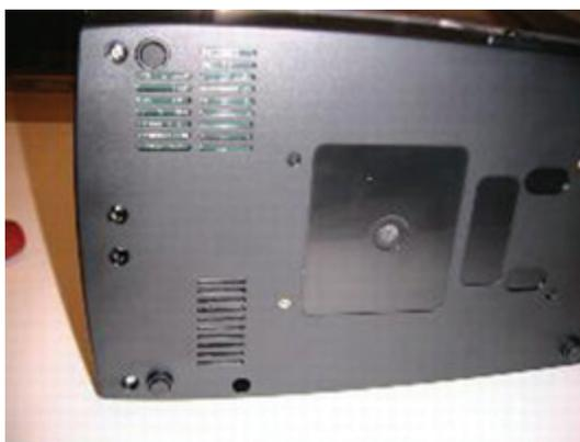
2) 轻轻将机壳推离挡板侧。然后，向上抬起挡板并抬离打印机。
