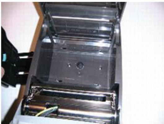
7) 找到机构右侧打印头下降开关后面的螺丝并拆下。
