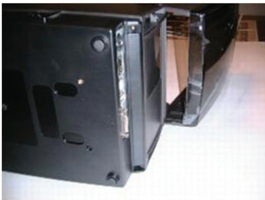
5) 通过卸下将介质导向装置固定到地板上的四个螺丝，拆下介质导向装置。
