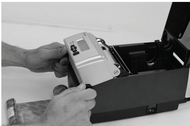
图 2-24. 打开打印头机构的门锁
