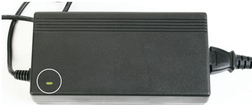
图 2-16. 电源上的绿色电源指示灯
