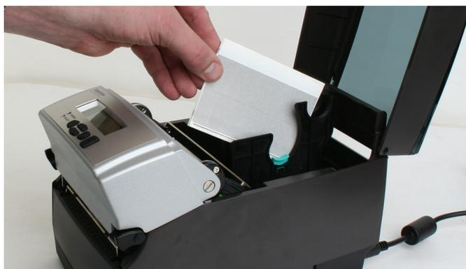
图 2-38. 从打印机内部取出生产测试样本
