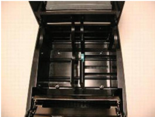
6) 拆下介质导向装置并放在一旁。卸下拆掉介质导向装置后露出的 2 个螺丝。
