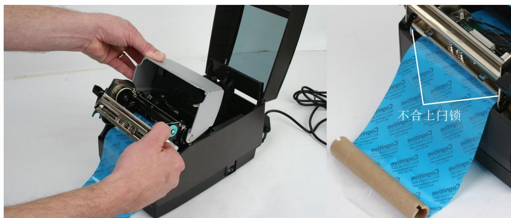
图 2-31. 在不关上打印头机构的情况下将该机构与用户界面分离，并向下放。
