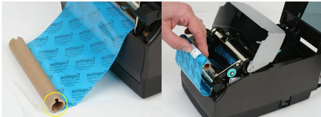
图 2-32. 卷取卷筒槽口和装载卷取卷筒
