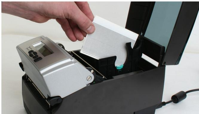
图 2-21. 从打印机内部取出测试样本
