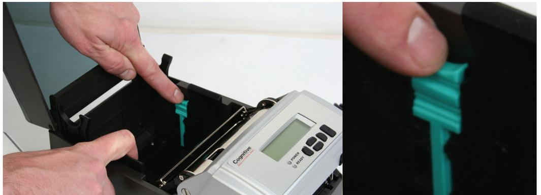
图 2-55. 介质导向装置锁定卡舌
