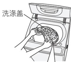
将洗涤盖的凹部嵌入洗涤筒的凸部并压放平整。
