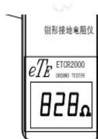
1. 钳口在钳绕了导体回路（而且电阻较大）的情况下进行自检。此时只须去除此导体回路后，重新开机即可。
