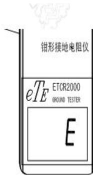
1. 钳口在钳绕了导体回路（而且电阻较小）的情况下进行自检。此时只须去除此导体回路后，重新开机即可。
