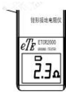
G. 如果在开机自检后，并没有显示电池符号，但每当压动钳柄时即自动停机，这也说明电池电压过低。应立即更换电池。
