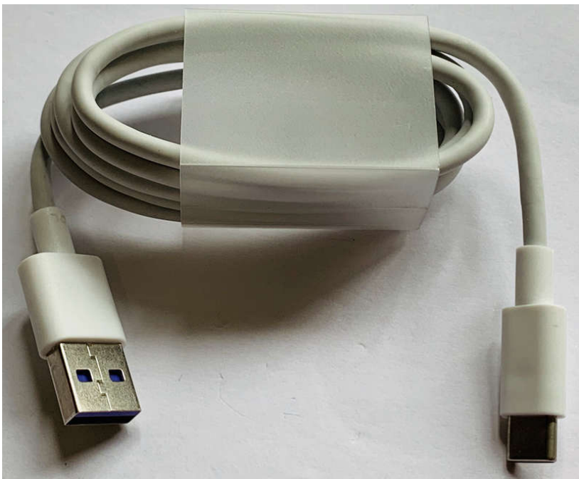
Type-C 专用测试线，支持 PD 电源母座的全面测试 5A A-C 线，用于测 USB-A 口的充电器
