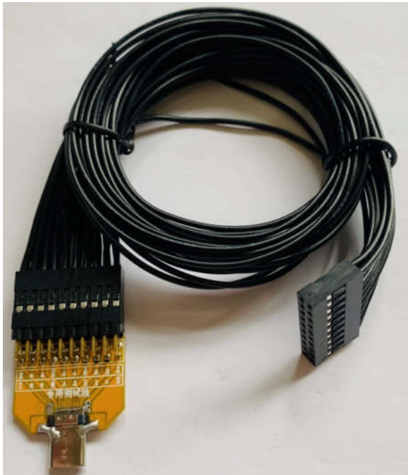
Type-C 专用测试线，支持 PD 电源母座的全面测试 5A A-C 线，用于测 USB-A 口的充电器
