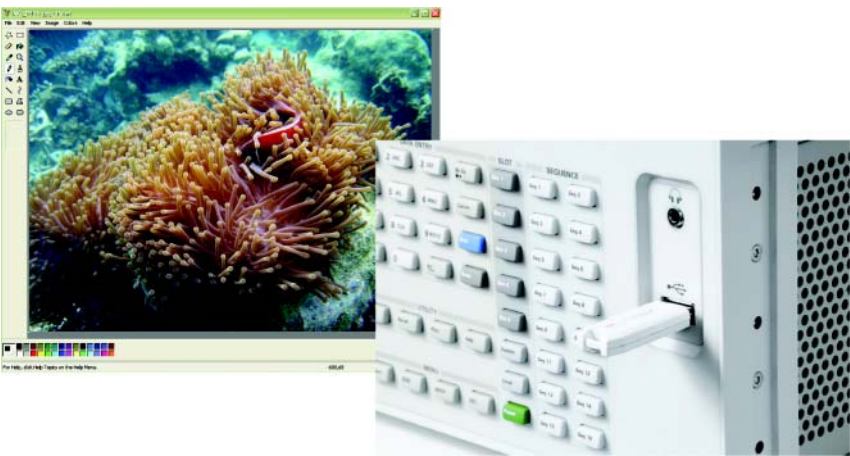
图 3. 通用 PC 接口与 USB U 盘进行自定义码型 / 图像、EDID、固件升级和文件的传输
