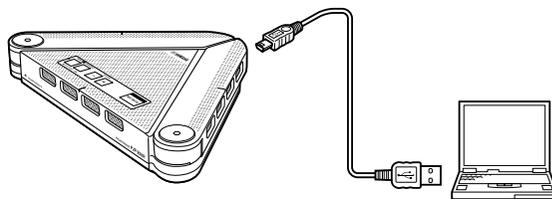
**Для подключения аппарата к компьютеру используется кабель USB.**
