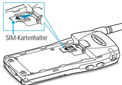
4. Setzen Sie die SIM-Karte unter den beiden Laschen an beiden Seiten der Akkuhalterung ein. Achten Sie dabei darauf, dass die abgeschnittene Ecke rechts oben liegt und die Goldkontakte zum Telefon zeigen.
