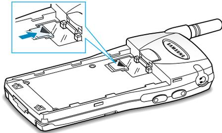
6. Bringen Sie den Akku wieder an. Dazu setzen Sie den Akku auf das Telefon auf und schieben ihn zur Verriegelungstaste, bis er einrastet. Vergewissern Sie sich, dass der Akku richtig eingesetzt ist, bevor Sie das Telefon einschalten.
