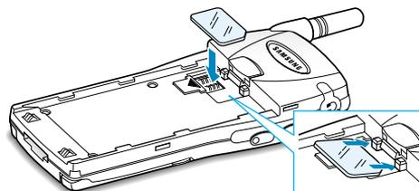
5. Halten Sie die SIM-Karte fest. Lassen Sie den SIM-Kartenhalter los, so dass er über die Karte gleitet und diese fixiert.
