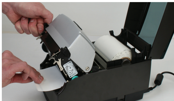
图 2-49. 将介质拉三到四英寸，然后放在滚筒中央
