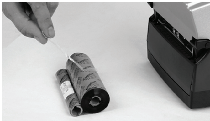
图 2-22. 取走色带上的胶带
