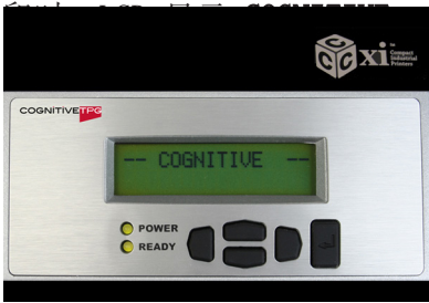
图 2-18：打印机通电时 CXI 打印机 LCD 显示的内容
