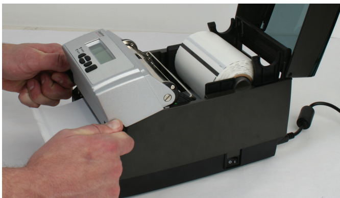
图 2-50. 栓上机构的门锁
