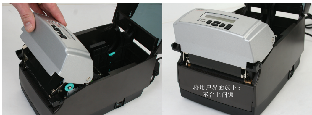
图 2-36. 在不闩锁机构的情况下放下用户界面
