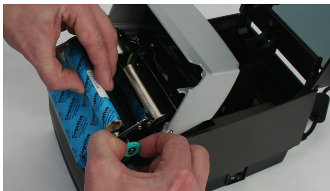
图 2-33. 将卷轴向外拉以插入卷取卷筒
