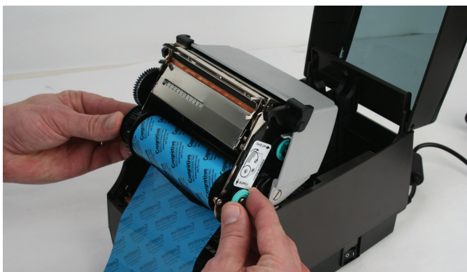
图 2-29. 将卷芯与色带转轴槽口对齐
