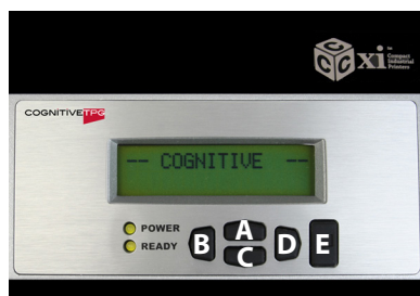
图 2-10. Cxi 打印机用户界面菜单按钮
