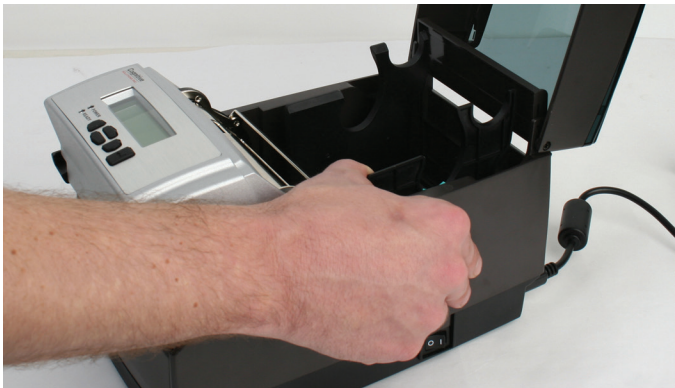
图 2-56. 打开介质导向装置
