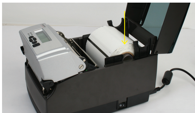
图 2-46. 下推卷筒右侧以锁定介质导向装置
