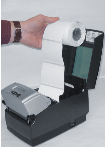
图 2-43b. 内卷介质的介质打 印侧必须朝上
