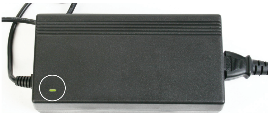
图 2-16. 电源上的绿色电源指示灯
