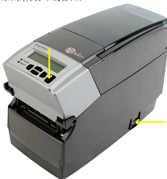
图 2-62. 执行打印机自检
