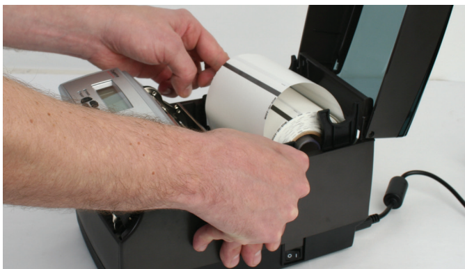
图 2-45. 将介质卷筒放入更低的介质导向装置插槽中
