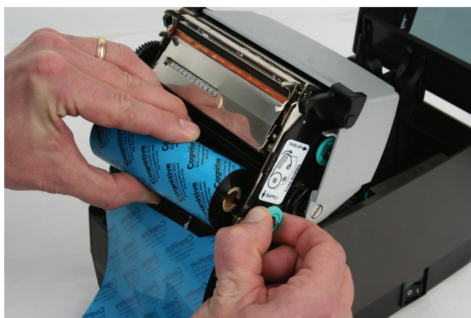
图 2-27. 将色带卷芯槽口与卷轴槽口对齐
