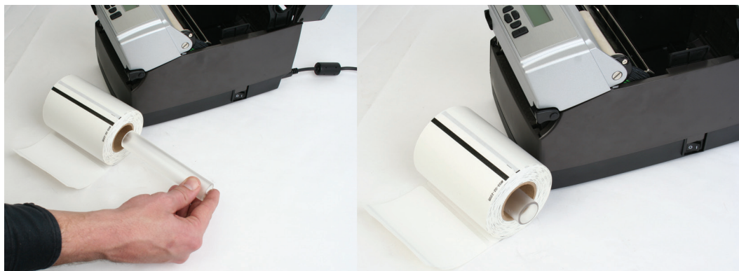
图 2-39a. 将转轴插入 CognitiveTPG 批准的内卷介质
