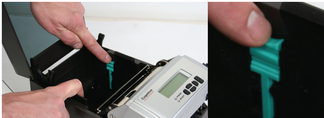
图 2-55. 介质导向装置锁定卡舌
