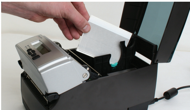
图 2-38. 从打印机内部取出生产测试样本
