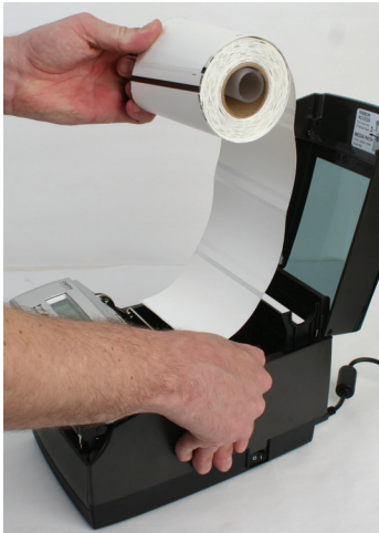
图 2-43a. 介质打印面 内卷介质的打印面必须朝上
