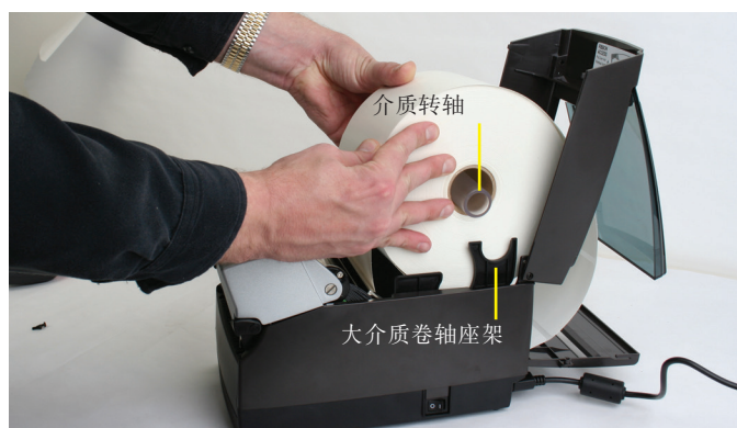
图 2-59. 打印面朝上装载大介质卷筒
