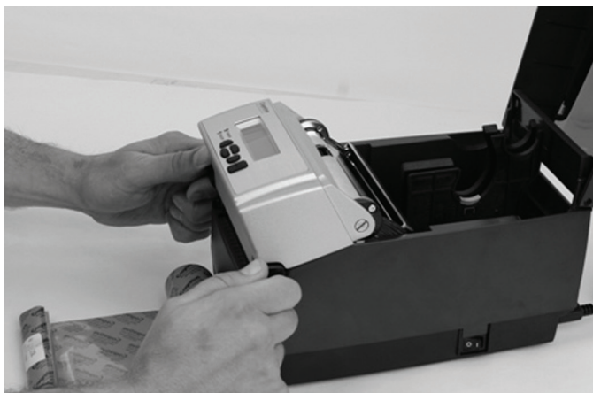
图 2-24. 打开打印头机构的门锁
