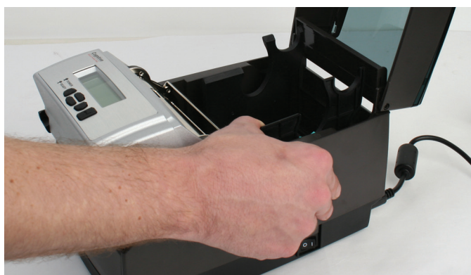
图 2-41. 展开介质导向装置
