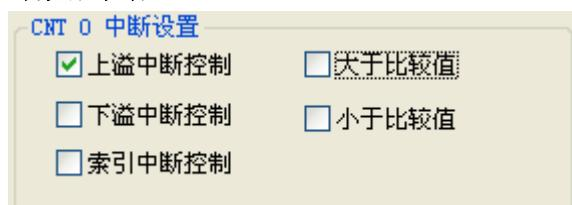
上溢中断控制：计数器值达到最大计数值上溢到0时产生中断信号
