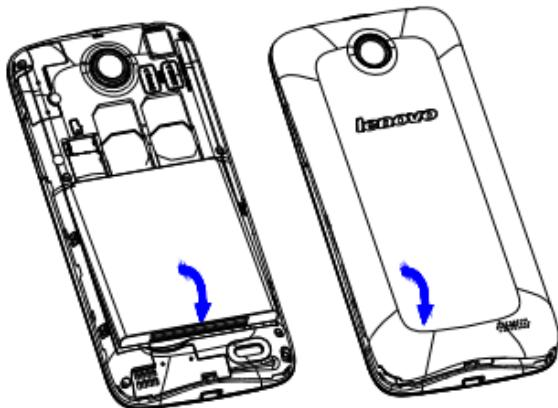
**警告：**拆卸电池之前一定要将手机关机并移去外部电源。绝对禁止在开机的情况下直接取出电池，否则可能损坏 SIM 卡和手机。
