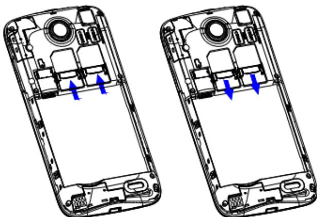
当您需要取出 **SIM** 卡时，请先关机，移去其他外部电源和电池，再取出 **SIM** 卡。
