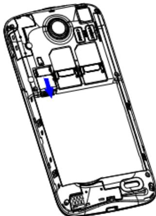
注意：卸载存储卡前，请先关机，否则可能引起传输至手机的文件丢失，或导致手机出现异常现象，无法正常工作。
