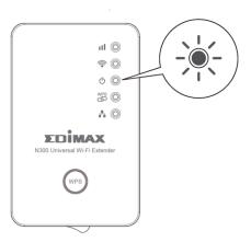
3. 請使用您的上網設備(如:電腦、平板或智慧手機)搜尋 SSID 為"Edimax.Setup"的 Wi-Fi 無線訊號,並且與它連線。
