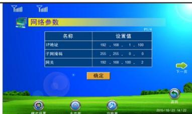
5. 用户可以根据具体情况设置通讯参数。包括“网络参数”、“BMS 参数”、“IEC-104 参数”以及“Modbus 参数”。
