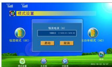
5. 在如图界面中输入电流指令，单击“启动”按钮，即开始并网恒流模式工作。
