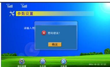
6. 输入错误密码，弹出如图所界面，点击“确定”，重新输入密码。
