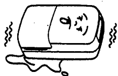
機體側放致使水溢出，容易損壞故障
