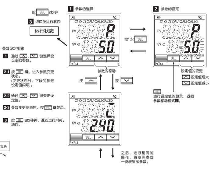
注) 上段(PV)显示消失(无显示)时, 请在参数DP13的设定值上加64。
