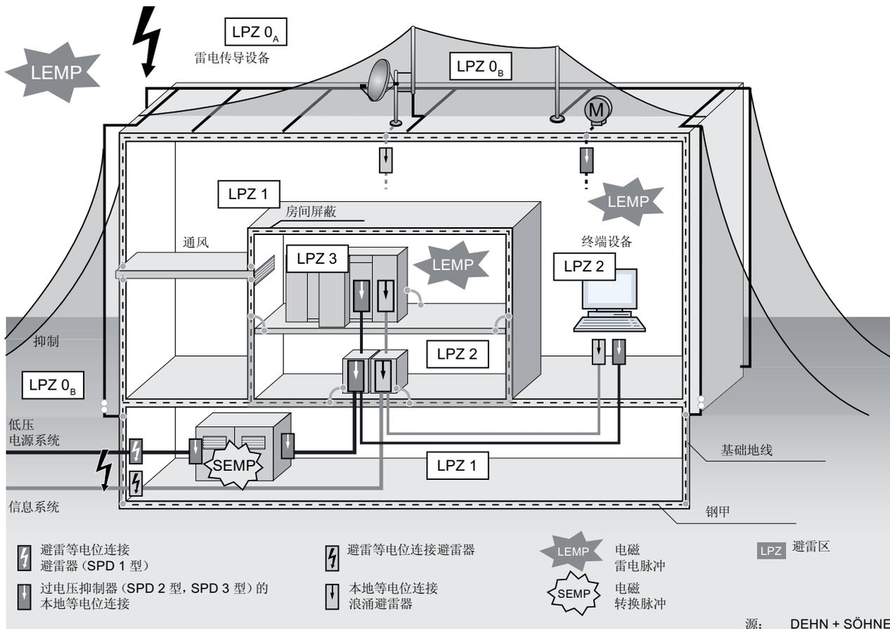
图 A-2 具有外部避雷的建筑物的避雷区
