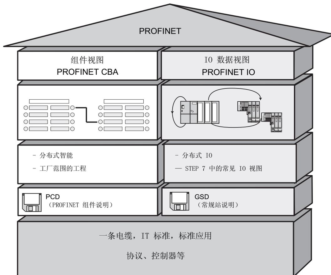
图 4-7 PROFINET CBA 和 PROFINET IO 的范围
