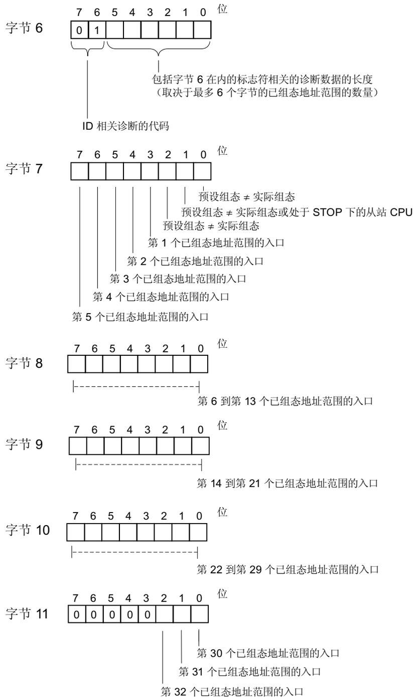
图 10-5 标识符相关的诊断数据
