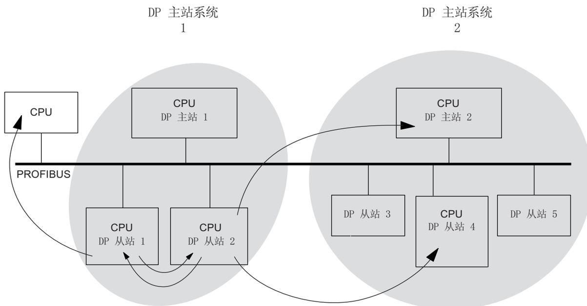
图 8-1 通过 DP CPU 进行直接数据交换
