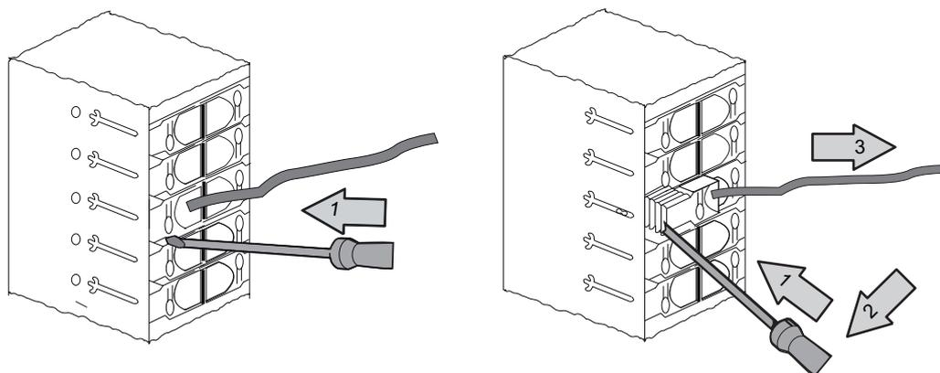
图 6-2 断开使用 40 针快速连接连接器进行的接线
