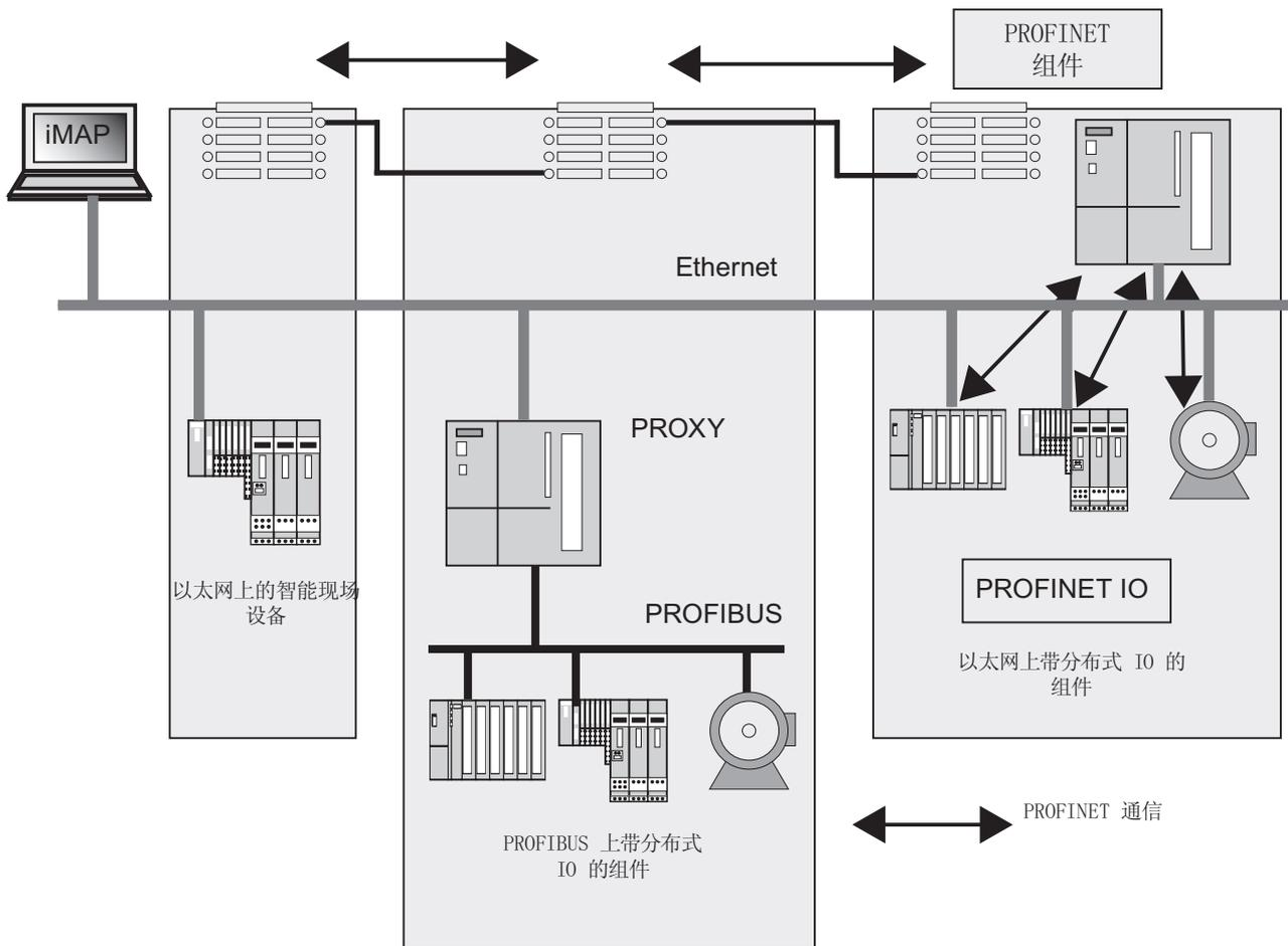
图 4-6 PROFINET CBA — 模块化概念
