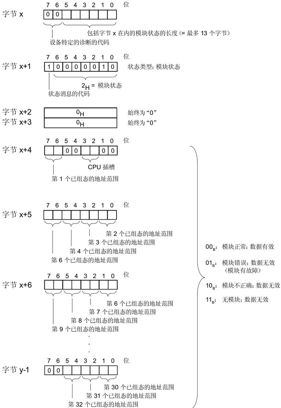
图 10-6 CPU 31xC 的模块状态的结构
