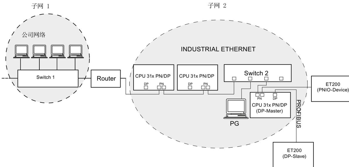
图 4-8 PROFINET 子网实例
