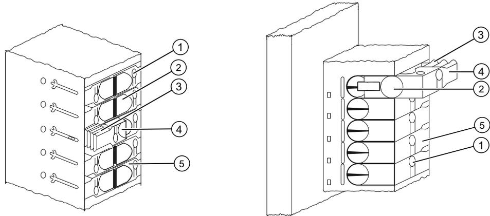
图 6-1 “快速连接”连接器的原理图表示
