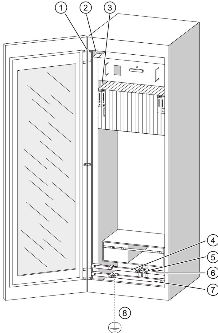
图 A-1 安装 EMC 兼容机柜的实例
