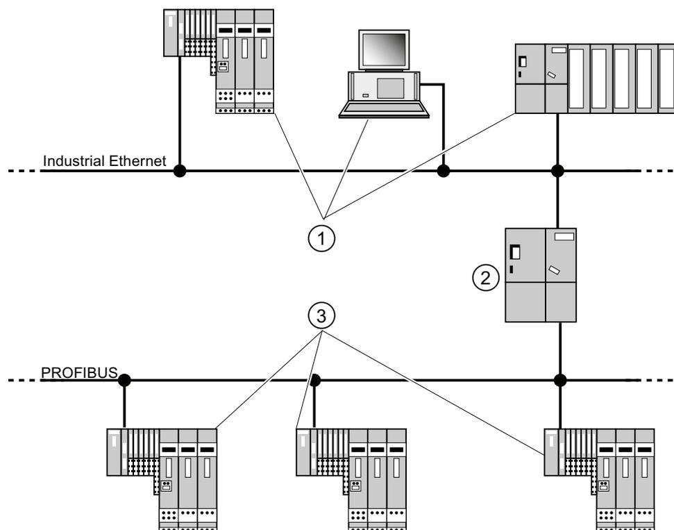
图 4-5 PROFINET 设备、PROFIBUS 设备和代理
