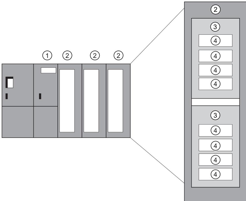
图 4-4 模块、子模块、插槽和通道
