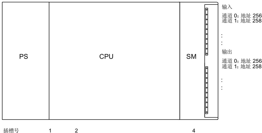
图 7-1 位于插槽 4 的模拟模块的 I/O 地址
