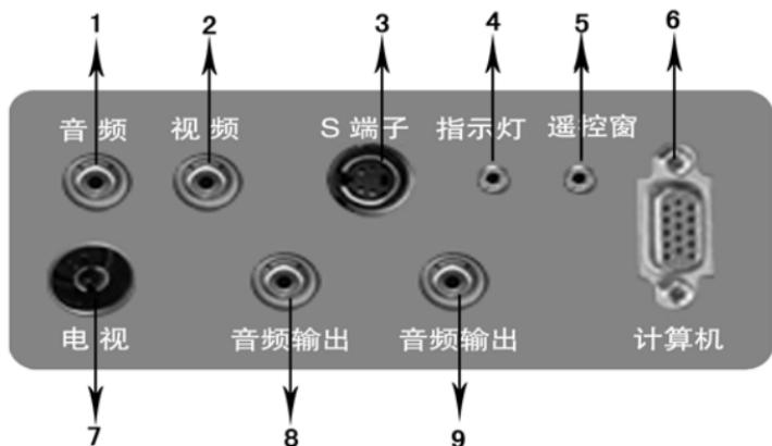
1) 音频输入插孔：这个插孔可以接收计算机或视讯来源的声音。
