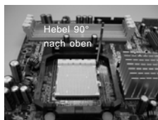
SCHRITT 1: Ziehen Sie den Sockelhebel hoch
