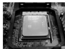
步骤 4： 下推并锁住插座拉杆
