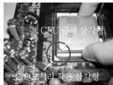
CPU 금색 삼각형 소켓 모서리 작은 삼각형 단계 2 / 단계 3. CPU 금색 삼각형을 소켓 모서리 작은 삼각형과 일치시킵니다
