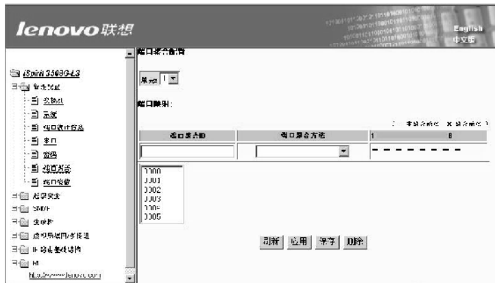
图5-14 端口聚合配置页面
