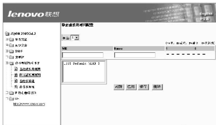
图 5-22 静态 VLAN 配置页面
