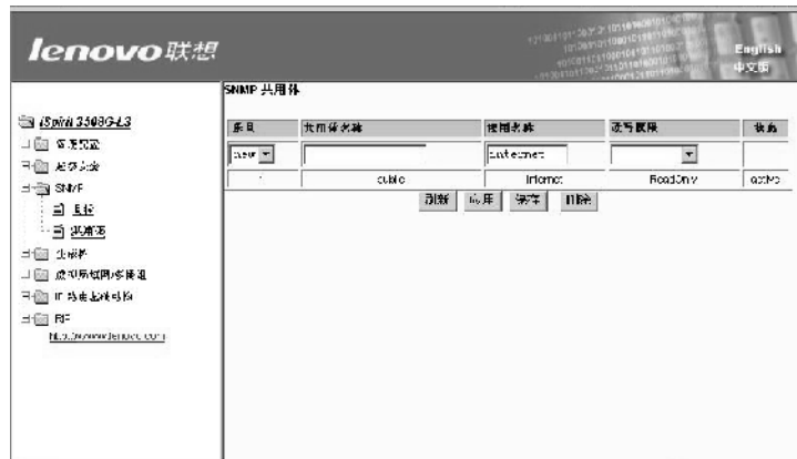
图 5-18 显示 SNMP 共用体页面
