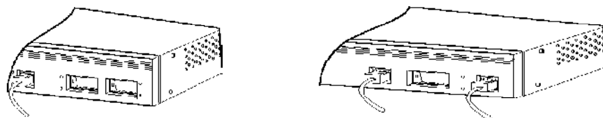
图 2-9 连接交换机 10/100/1000 Base-T 端口
