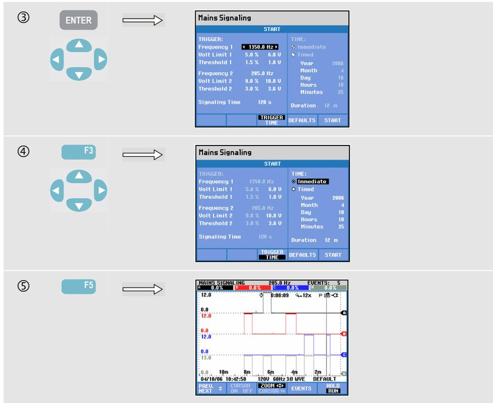
曲线从右侧逐步形成。表头部位的读数与右侧所绘的最新数值相对应。利用上/下箭头键，您可以标称线电压的百分比或 3 秒平均电压 V3s 来作为读数单位。电力线发信功能不使用中性线，但为了方便故障诊断，中性线也一并显示。
