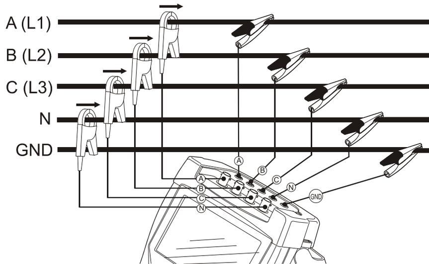
图 6-2. 将分析仪与三相配电系统连接
