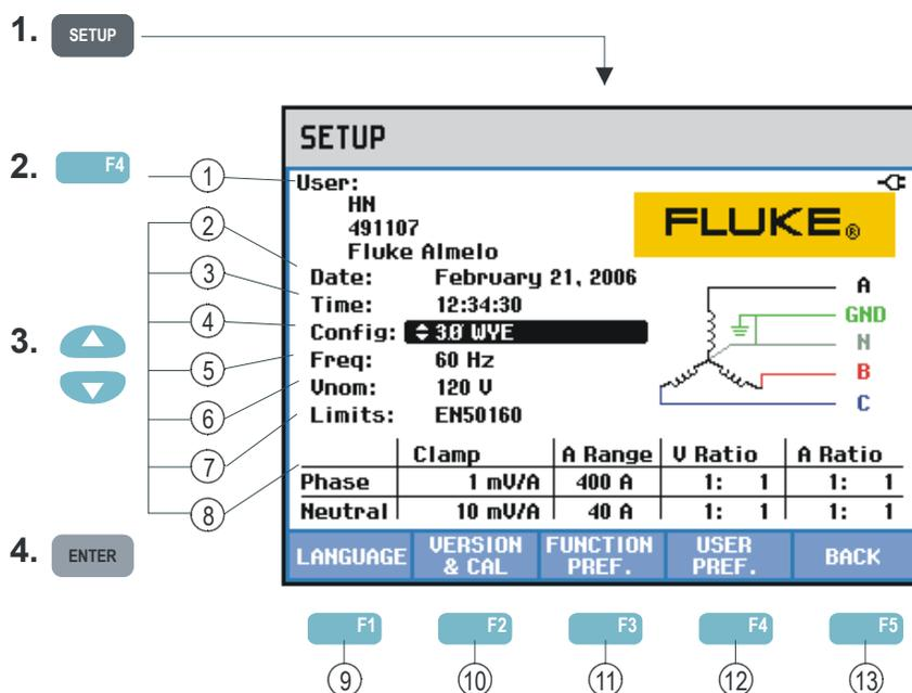
实际设置值显示在设置（SETUP）入口屏幕中。使用上面描述的键操作更改项目。
