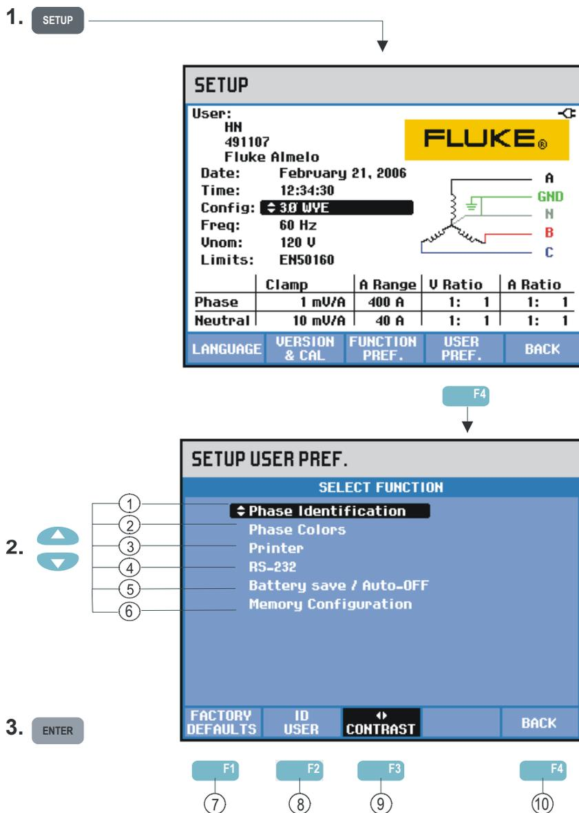
用户参数选择（USER PReFerences）可让您自定义相位标记（Phase Identification）和颜色（Colors）、打印机（Printer）和 RS-232 设置、自动关闭、内存配置、用户名/地址定义（如入口屏幕所示）及显示屏对比度。许多菜单都有一个功能键供重置为出厂默认设置。
