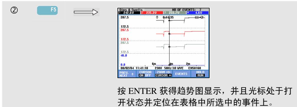
按 ENTER 获得趋势图显示，并且光标处于打开状态并定位在表格中所选中的事件上。
