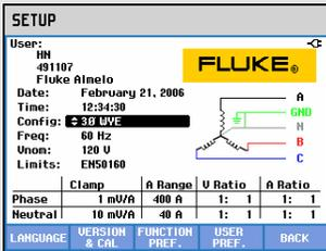
当前配置在 Config 之后指示。Config 被高亮显示表示按 ENTER 键后，可以对它进行调整。相关的配置符号显示在屏幕的右侧。
