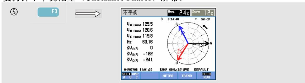
在以 30 度为单位分割的矢量图中显示电源和电流的相位关系。基准通道 A（L1）的矢量指向水平正方向。在示波器相量（Scope Phasor）中也显示一个相似的矢量图。还给出其它数值：负序电压或电流不平衡百分比、零序电压或电流不平衡百分比、基相电压或电流、频率、相角。利用功能键 F1，您可以选择所有相位电压、相位电流或各相中电压和电流的读数。
