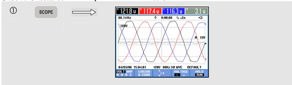
示波器波形（Scope Waveform）屏幕中以示波器样式快速更新电压和/或电流波形的显示。屏幕表头部位显示相关的 rms 有效值电压/电流值（依照 IEC61000-4-30 为 12 或 10 个周期的 rms 有效值）。依照默认，显示两个波形周期。通道 A（L1）是基准通道，显示从 0 V 开始的两个完整周期。
