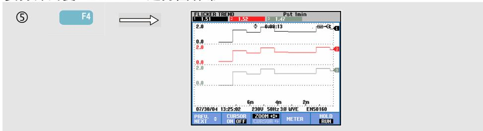
计量屏幕中的参数随时间更新。无论何时，当测量启动时，它们就被记录下来。趋势图显示这些值相对于时间的变化。计量屏幕中的所有数值都被记录下来，但计量屏幕中每一行的趋势图（Trend）每次只能显示一个。按功能键 F1 来将箭头键分配给行选择。趋势图显示画面可由 6 个屏幕组成。
