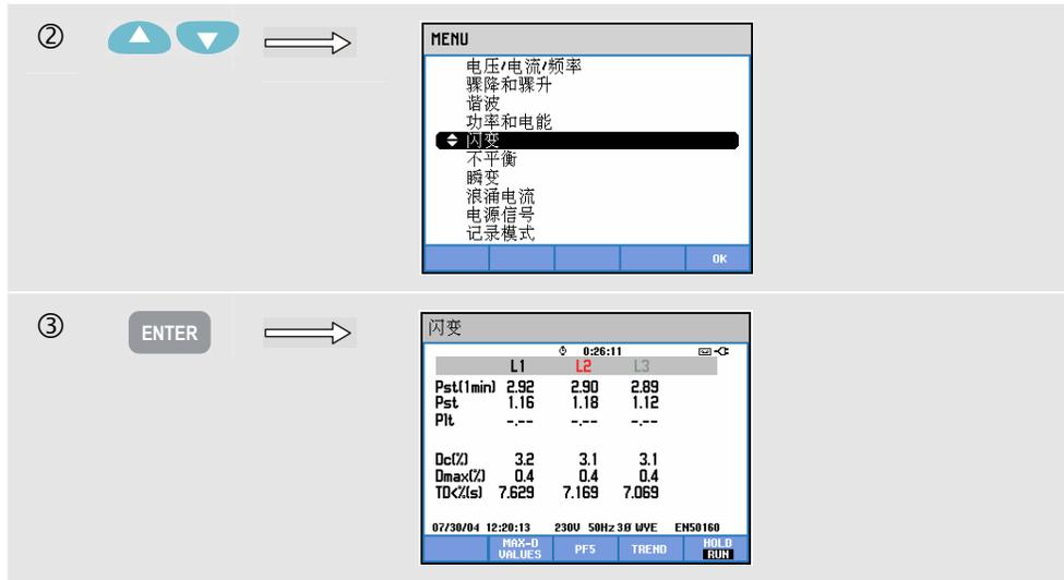
闪变的特征包括：短期严重性 Pst（在 1 分钟时间内测得，用于快速反馈）、短期严重性 Pst（在 10 分钟时间内测得）及长期严重性 Plt（在 2 个小时时间内测量）。该数据以及相关的 D 参数 Dc、Dmax 和 TD（依照 EN61000-3-3）均在计量屏幕中显示。
