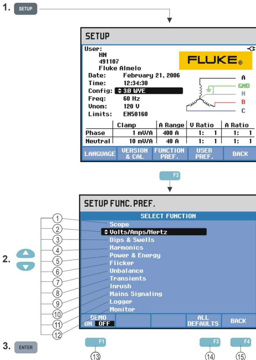
功能参数选择（FUNCTION PReferences）让您能够自定义测量功能的数据表示方式。这涉及比如趋势图和波形显示的偏移（Offset）和跨距（Span）。入口菜单可以选定的信息语言显示。下表概括列出了每项功能可调整的项目内容。下表概括列出了每项功能可调整的项目内容。当您调整其设置时，测量功能仍然保持活动状态。这让您能够直接判断调整的结果。
