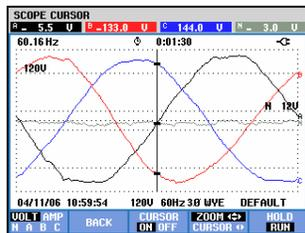
图 19-3. 波形显示（光标和缩放功能启用）
