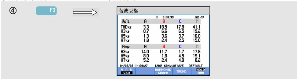
计量屏幕画面中每个相位显示 8 个测量值。使用设置（SETUP）键和功能键 F3 — 功能参数选择（FUNCTION PEF），您可以选择屏幕内容。详细信息，请参阅第 18 章，功能参数选择。
