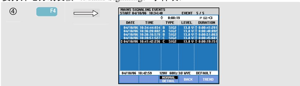
事件表在常规模式下显示测量期间发生的事件 (超过极限值的 V3s)。表中列出了每个事件的日期、时间、类型 (相位, 信号 1 或信号 2)、电平及持续时间。在详细 (Detail) 模式下, 显示有关各门限交叉点的更多附加信息。
