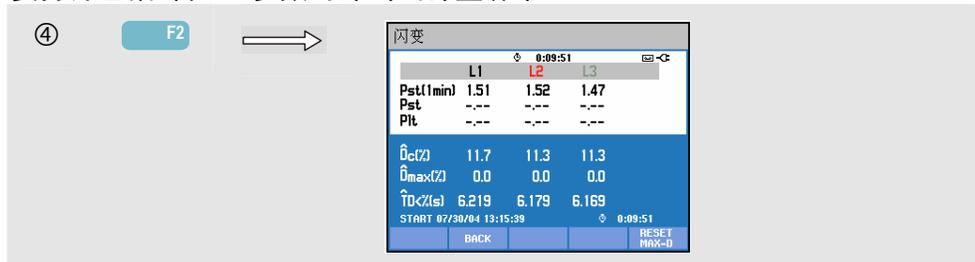
Pst 和 Plt 是显示一定时间段内的闪变的参数。瞬时闪变显示在 PF5 子菜单中，可用功能键 F3 查看。闪变 PF5 以快速趋势图（Trend）图形显示。
