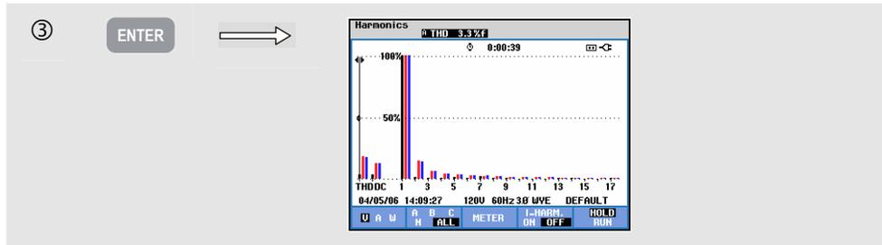
条形图显示画面中显示与满信号相关的各分量对满信号影响的百分比。无失真的信号应显示第一次谐波（=基波）在 100 % 而其它信号位于零；而实际情况不会发生这种情况，因为总是存在一定数量的失真而导致谐波较高。
