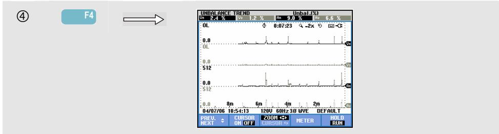
计量屏幕中的数字是持续更新的即时值。任何时候，只要测量在进行中，这些值相对于时间的变化都被记录下来。计量屏幕中的所有数值都被记录下来，但计量屏幕中每一行的趋势图（Trend）每次只能显示一个。按功能键 F1 来将箭头键分配给行选择。趋势图显示画面可由 6 个屏幕组成。
