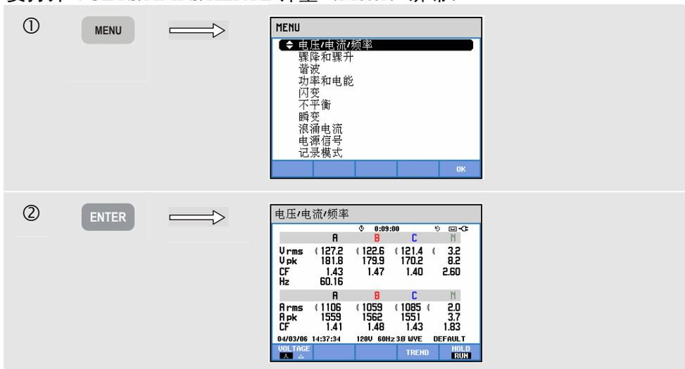
计量屏幕概括列出了所有相位上的电压和电流。频率和波形因数（CF）也在屏幕中显示。波形因数（CF）表示失真的程度：波形因数 1.41 表示没失真；高于 1.8 表示高度失真。在用其它测量模式详细检查系统前，可利用该屏幕初步了解电力系统的性能。计量屏幕中的列数取决于电力系统的配置。
