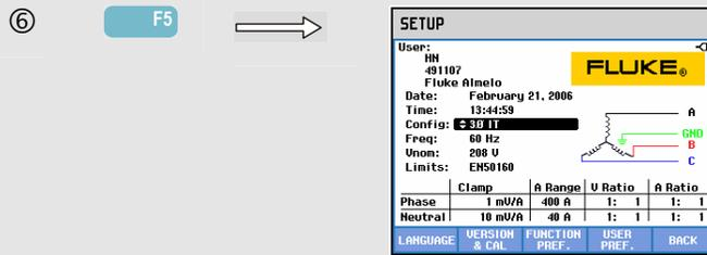
返回至设置（Setup）入口屏幕。新的配置显示在 Config.后并且相关的配置符号也显示在屏幕的右侧。
