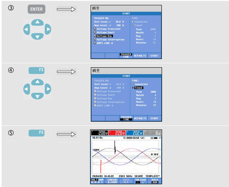
在开始 (Start) 菜单中，您可以选择一个触发事件或一组触发事件、瞬态电压 (Volt) 和电流 (AMP) 触发电平，以及选择立即 (Immediate) 或定时 (Timed) 启动测量。
