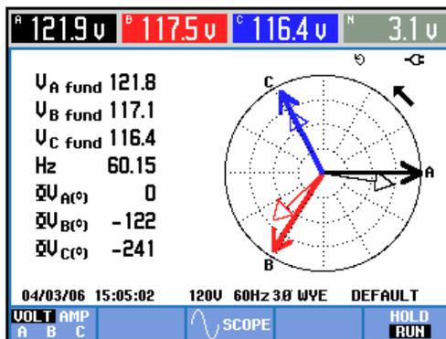
图 6-3. 正确连接的分析仪的矢量图
