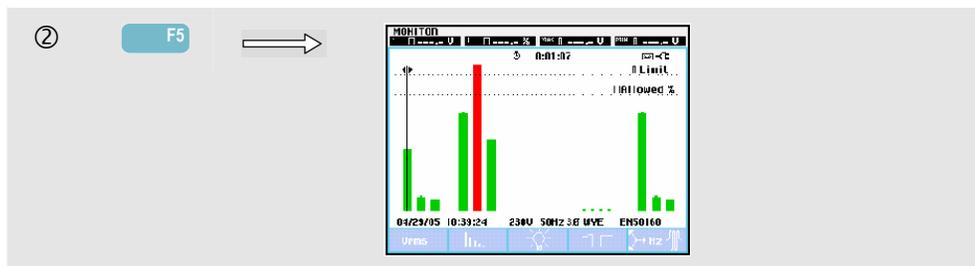
电力质量监测（Power Quality Monitoring）可通过监测（MONITOR）键使用，及通过菜单来设置立即（Immediate）或定时（Timed）启动。利用左/右箭头键，您可以将光标（Cursor）定位在某个条形图（Bar Graph）上。与该条相关的测量数据被显示在屏幕的表头部位。
