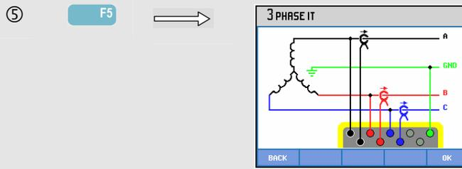
出现一个信息屏幕，告知您如何将分析仪与所测电力系统连接。完成后按 F5。
