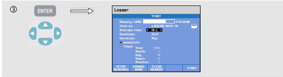
待记录的读数组可在功能键 F1 – 设置读数 (SETUP READINGS) 下的菜单中选择。利用上/下箭头键，您可以选择五组预先定义的读数 (默认 1 – 5) 和两组用户定义的读数 (用户 1 和用户 2)。表 17-1 是默认 1 ... 5 下可用读数的概览。这也让您对可用于记录的读数有一个印象。
