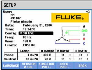
按设置 (SETUP) 打开设置入口屏幕。
