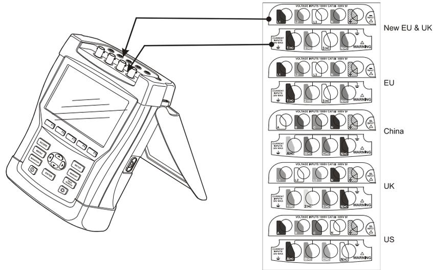
图 6-1. 安装电压和电流输入端贴纸
