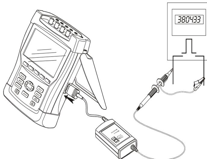
图 11-1. 利用脉冲输出验证能量计
