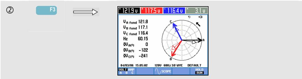
相量（Phasor）屏幕是在矢量图中显示电源和电流的相位关系。基准通道 A（L1）的矢量指向水平正方向。其它数值包括基波相位电压、频率和相角。屏幕表头部位显示 rms 有效值电压和/或电流值。
