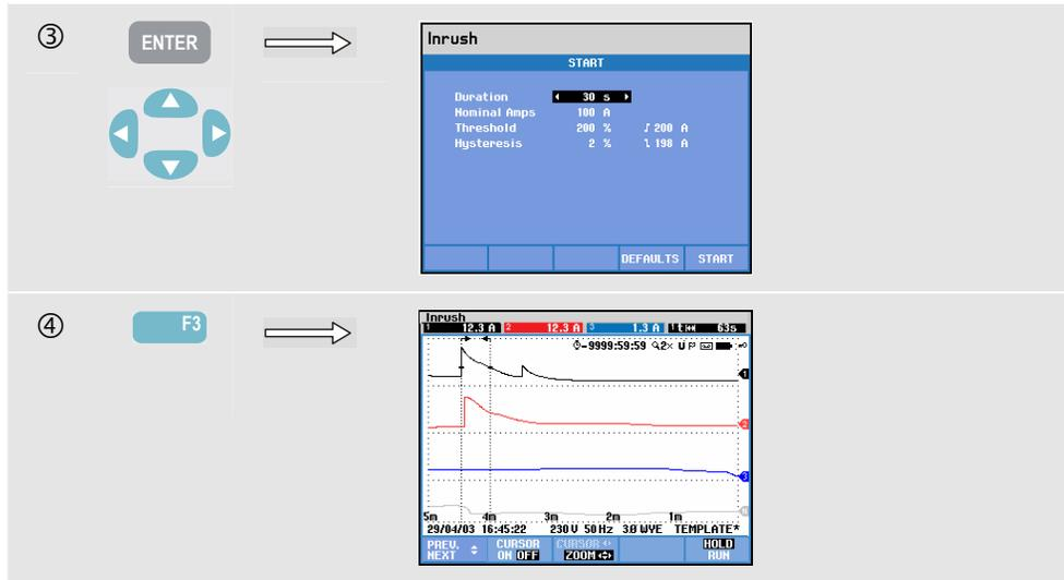
在开始（Start）菜单中使用箭头键来调整触发极限值：预期浪涌时间、标称电流、门限和滞后。最大电流决定电流显示窗口的垂直高度。门限是触发趋势图捕捉的电流电平。浪涌时间是指从触发到电流下降至由滞后表示值期间的的时间。浪涌时间在趋势显示图的两个垂直标记之间表示。屏幕表头部位在浪涌时间内显示所有 rms 值的有效值。如果光标（Cursor）启动，就能显示光标位置的 rms 有效测量值。
