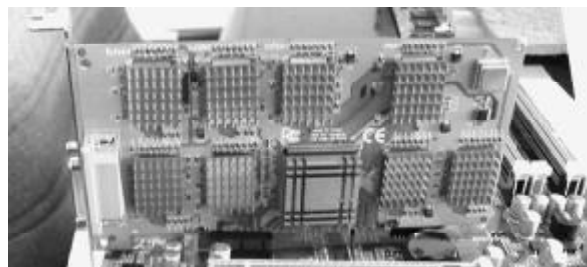
图 3 PCI-E-1X 接口的采集卡插在 PCI-E 1X 插槽上
