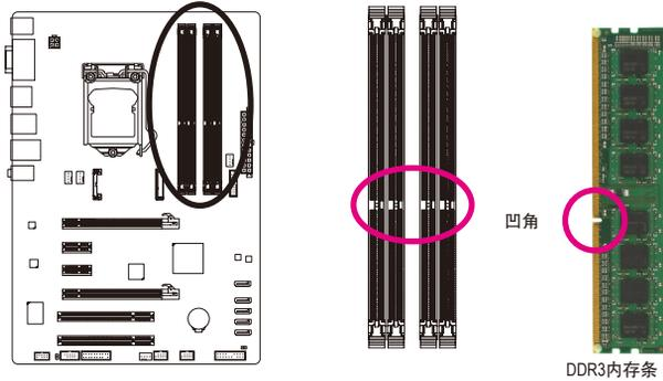
DDR3内存条上有一个凹角，只能以一个方向安装至内存条插槽内。请依下列步骤将内存条正确地安装于主板的内存插槽内。
