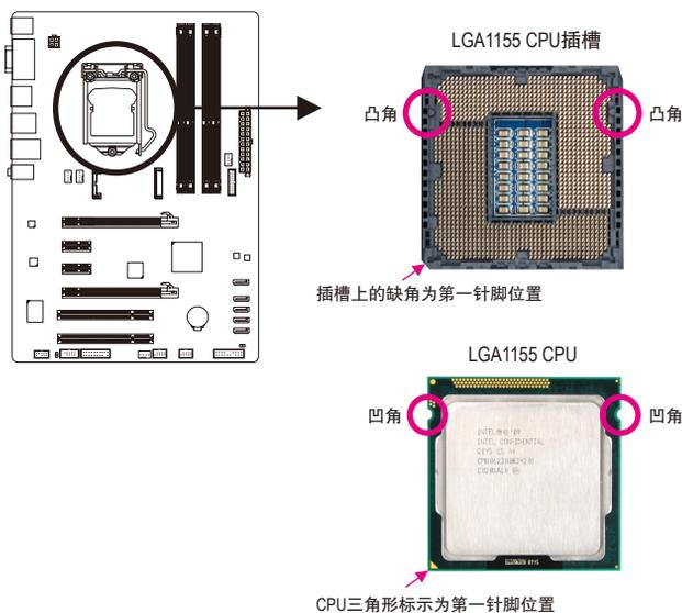
B. 请依下列步骤将CPU正确地安装于主板的CPU插槽内。
