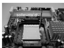
FASE 1: Sollevare la levetta socket
