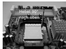
SCHRITT 1: Ziehen Sie den Sockelhebel hoch
