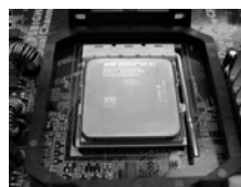
步骤 4： 下推并锁住插座拉杆
