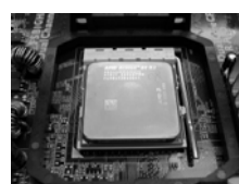
FASE 4: Abbassare e bloccare la levetta socket
