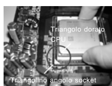
FASE 2 / FASE 3: Far corrispondere il triangolo dorato della CPU al triangolino nell'angolo del socket
