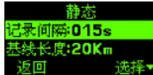
进行静态测量时，需设置记录间隔、基线向量长度等参数。
