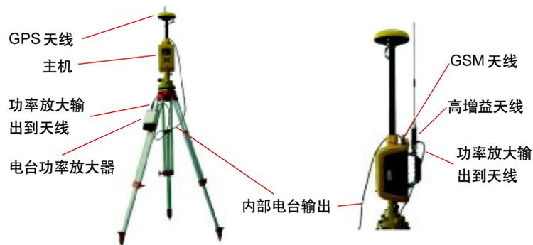
当流动站和基准站距离较近时(100米以内),可以直接将UHF天线射频接口,连接到E630G主机的UHF天线接口,并固定在E630G的手柄上。
