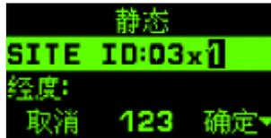
这一位要求输入大写字母“C”，所以要先按两下功能键【FN】屏幕切换成下图状态：
