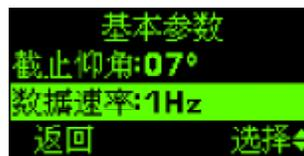
基本参数中有八个子项：截止仰角、数据速率、相位中心调整、天线垂高、天线类型、PDOP值、最小卫星数、保存参数，“保存参数”把前几项设置的参数保存到 **E630G** 内部。
