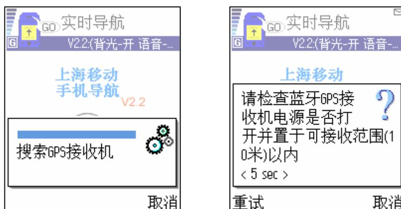
GPS 接收机搜索成功后，系统会给出正在等待 GPS 定位的提示，在 2 分钟内依然无法获得需要的 GPS 信号，系统会给出“GPS 信号弱”的提示：
