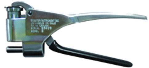
B 型主要应用于铝和铝合金（系列 1100—7075）的硬度测量。亦可以用来测量某些钢和铜合金的硬度，其测量范围为：
