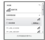
2 在下图的空格内,输入电力线AP所设置的PSK密码(英文字母区分大小写),单击“确定”。
