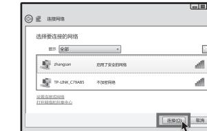
3 请按照提示输入电力线AP所设置的PSK密码,单击“确定”。当画面提示成功连接时,表示已成功加入该网络。
