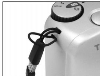
**3** Ziehen Sie den Tragegurt durch die Schleife, bis die
