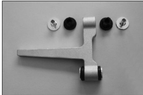
44. Assemble the Anti-Vibration Engine Mount. 防震引擎座以及組件。
