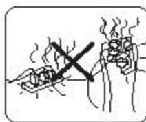
应根据电视机的电源消耗功率单独设置专用的电源插座，勿与其它电器共用插座。
