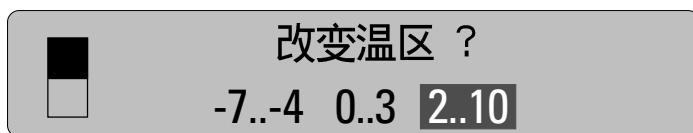
使用“<”键选择“0..3”，并触摸“确定”键确认选择，显示屏中将出现下图信息。
