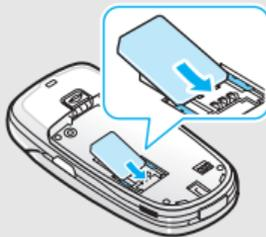
确保 SIM 卡金属触点面朝向手机。
