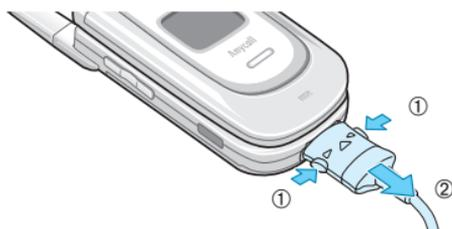
**注意：**在充电过程中，必须在拔下充电器之后，再从手机上取出电池；否则会损坏手机。
