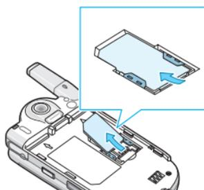
4. 将电池放回手机的后部。要注意将电池底部的卡齿插入对应的卡槽中。
