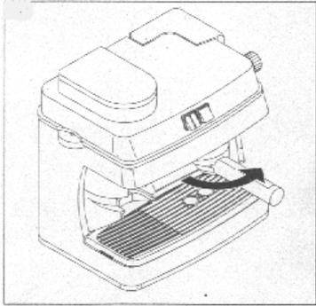
5、安装过滤器：把过滤器对准咖啡出口上的卡口，轻轻上抬到位后再逆时针扭转把手，扭紧即可。
