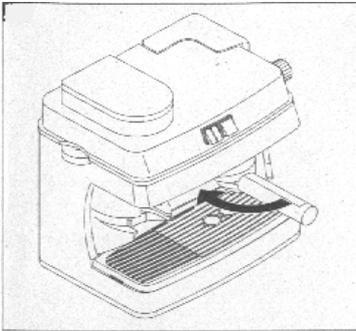
7、卸下过滤器，最好再次按下咖啡开关，冲掉输出口的咖啡渣，可同时用毛刷轻轻刷输出口。把过滤器里的咖啡渣倒掉再用清水冲洗干净不用时装回机器上即可。
