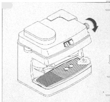
1、放水—（机器在第一次使用或长时间未使用时，需要先进行此项）把卡布其诺输出口对准废水盘，打开电源开关，这时开关里的指示灯会亮，把热水/蒸汽钮逆时针旋转到底，再打开咖啡开关，过一段时间，会有水从卡布其诺输出口流出，等到有持续稳定的水流流出后，再关上咖啡开关，顺时针扭转热水/蒸汽钮，关闭阀体。
