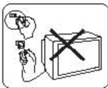
应注意保护灯电视机的电源及插头，切勿因误接高压使其损伤。
