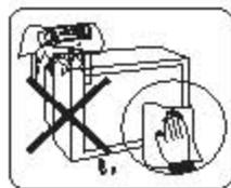
勿用酒精、强水、强碱剂等清洗电视机表面，若确有需要，请用海绵或软布(可加少量中性洗涤剂)的干布清洗，并切记在清洗前切断电源。
