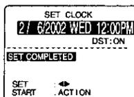
Si "AUTO CLOCK SET IS INCOMPLETE" aparece en pantalla, coloque el tiempo usando el procedimiento manual (MANUAL CLOCK SET), vealo enseguida..
