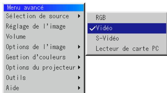
Vous permet de sélectionner une source vidéo tel qu'un magnétoscope, lecteur DVD, lecteur de disque laser, ordinateur ou caméra en fonction de la connexion aux entrées. Appuyez sur la touche "Sélection" du coffret du projecteur ou sur les touches st de votre télécommande pour mettre en surbrillance le menu de l'élément à ajuster.
