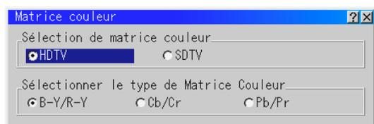
Sélectionnez d'abord une matrice couleur appropriée adaptée au signal de composant pour la HDTV ou SDTV. Ensuite, sélectionner un type de matrice approprié parmi B-Y/R-Y, Cb/Cr ou Pb/Pr.
