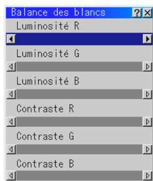
Utilisez la touche ◀ ou ▶ pour régler la balance des blancs. La luminosité pour chaque couleur RGB est utilisée pour régler l'intensité du noir de l'écran. Le contraste pour chaque couleur RGB est utilisé pour régler l'intensité du blanc de l'écran.
