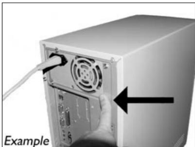
**ES** Toque una parte metálica no pintada (por ejemplo, radiador o cualquier parte no pintada de las carcasa de su ordenador).
