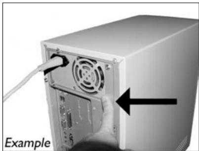
**Example****ES** Toque una parte metálica no pintada (por ejemplo, radiador o cualquier parte no pintada de las carcasa de su ordenador).
