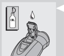
**3** ทุกๆ หกเดือน ควรหยดน้ำมันจักรเพื่อหล่อลื่นซี่ฟันของที่กันจอน
