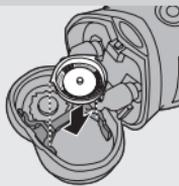
**4** 將電鬚刀刀頭裝回電鬚刀組，並將固定架裝回電鬚刀組。
