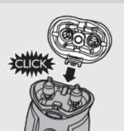
**5** 將鉸鏈插回鬚渣室邊緣的槽孔中，並將其推回原位 (會聽見「喀嗒」一聲)，即可輕易地裝回電鬚刀組。
