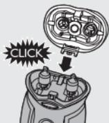
**5** 將鉸鏈插回鬚渣室邊緣的槽孔中，並將其推回原位(會聽見「喀嗒」一聲)，即可輕易地裝回電鬚刀組。
