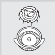
**3** Làm sạch các lưỡi cạo và nắp bảo vệ bằng bàn chải cấp kèm với máy.
