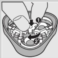
**7** Letakkan balik kepala pencukur ke dalam unit pencukur. Letakkan balik rangka penahan ke dalam unit pencukur (1) dan putar roda ikut arah jam (2).
