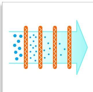
过滤系统包含四个独立的隔层。这可确保所有尘埃均被捕捉到吸尘器中。
