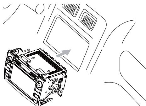
6 用螺钉将本装置固定到仪表板上。
