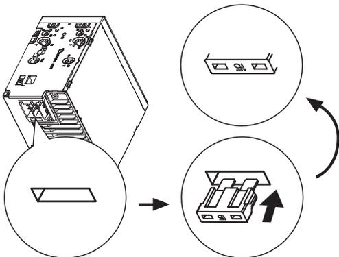
如果更换后保险丝立即熔断，则可能存在内部故障。在这种情况下，请咨询 Philips 经销商。
