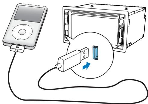
1 通过 Apple 的 30 针 USB 线缆将 iPod/iPhone 连接至 USB 插孔。
